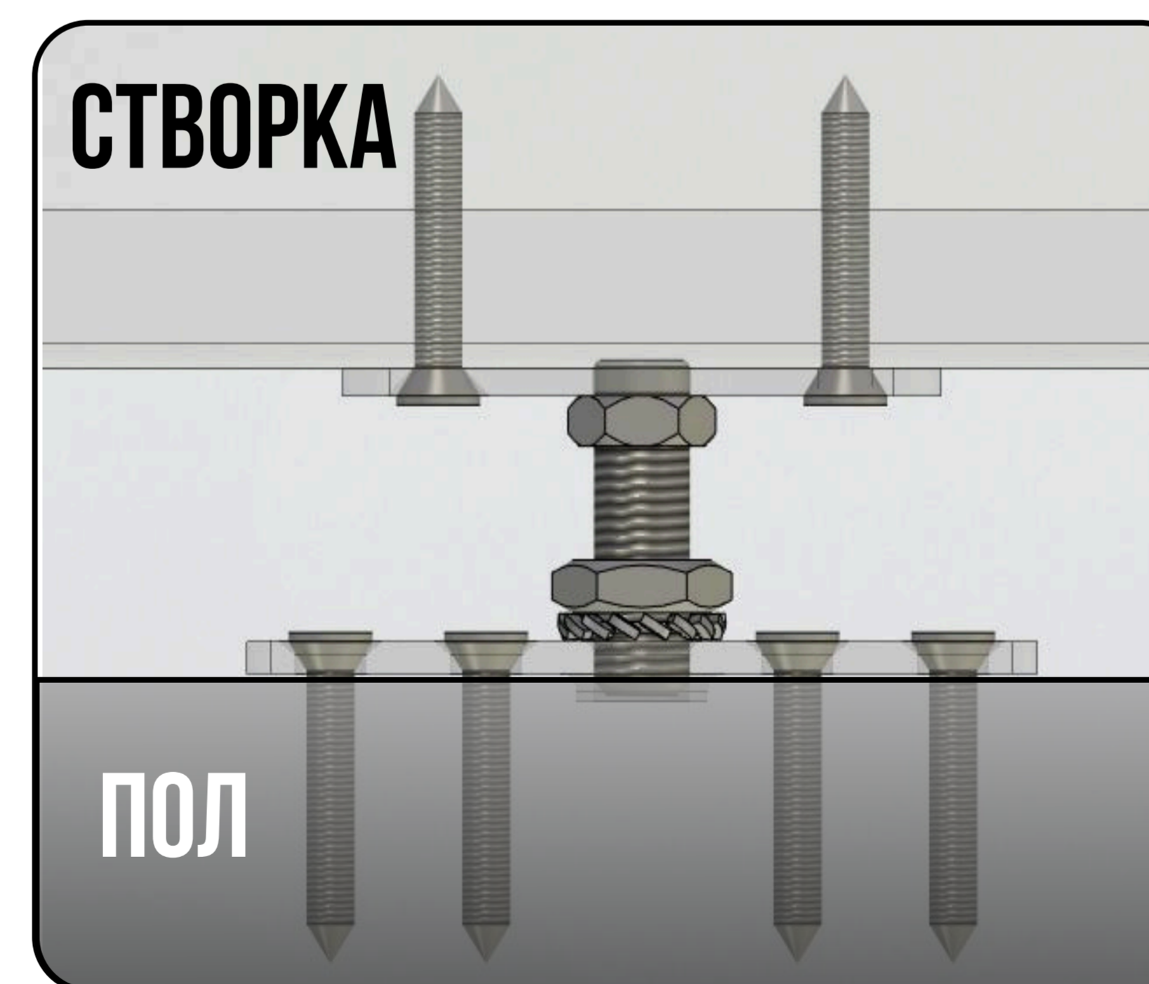
Нижний узел крепления неподвижного полотна
