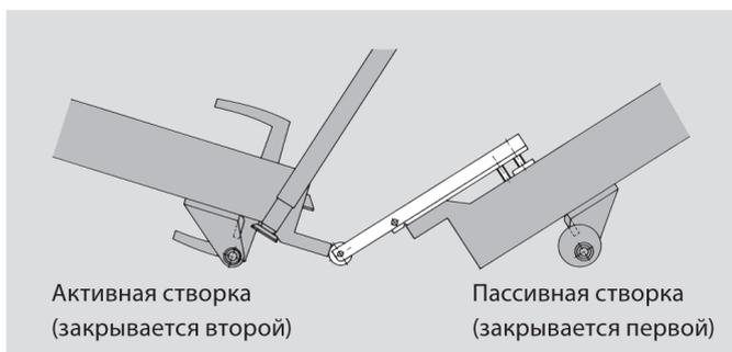
– толкатель для двухстворчатых дверей, оборудованных координаторами последовательности закрывания створок.
